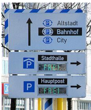
Abbildung 8: Kombination aus statischem und dynamischem Parkleitsystem
